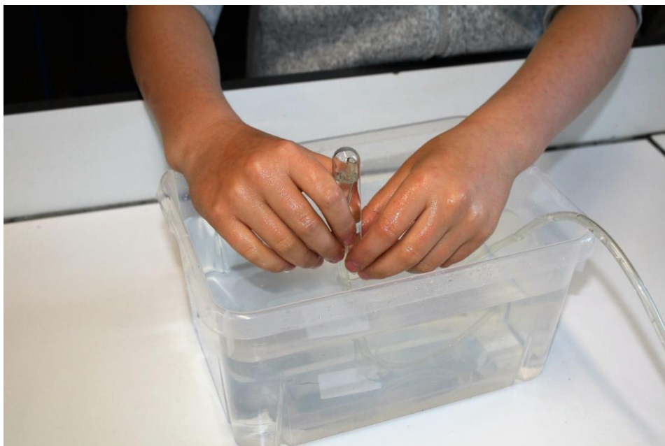
Image 3 : tenez le tuyau souple dans le bac rempli d'eau
